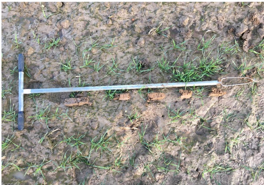
Figure 2. Sondage à l'emplacement du futur bâtiment
